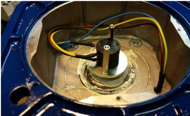
Solde los cables al nuevo potenciómetro y ponga el potenciómetro en su lugar insertando el eje de éste en el agujero asegurándose que el pasador entre en la ranura transversal al agujero.
