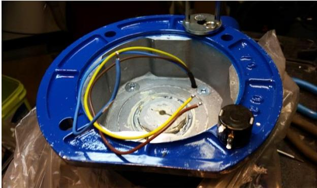
Corte o desolde los cables del potenciómetro.
