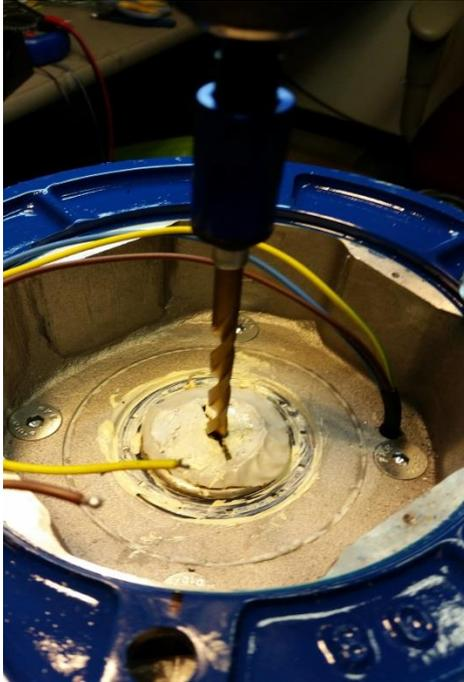
Si es necesario, use una broca de  $\frac{1}{4}$  de pulgada (6.35 mm) para agrandar el agujero donde se inserta el eje del potenciómetro. Remueva cualquier residuo metálico producido por el taladro.
