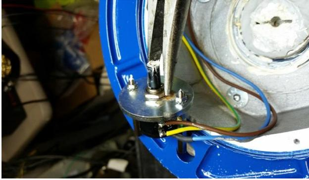
Remueva el potenciómetro de su plataforma quitando la tuerca y arandela dentada que lo fijan a ésta.
