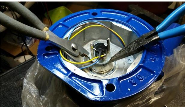
Si el potenciómetro y su plataforma no salen fácilmente, use dos herramientas que puedan hacer palanca para sacarlos. Estas palancas deben ejercer fuerzas simétricas a ambos lados para evitar que se parta el eje del potenciómetro, ya que normalmente este eje es de plástico.
