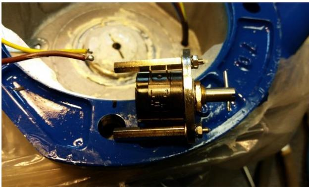
Instale el nuevo potenciómetro en la plataforma . Ponga el pasador a través del eje del potenciómetro. Se pueden aplastar los extremos del pasador para impedir que éste se salga del agujero.
